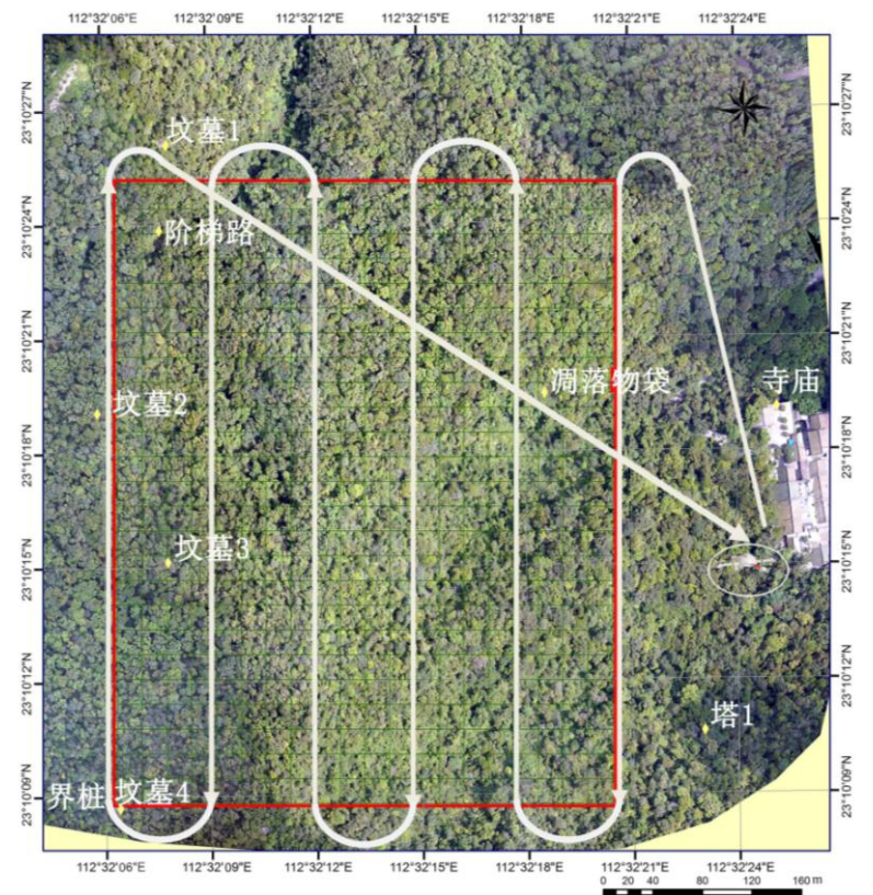
图注: 白色线条为无人机飞行路线; 红色线条为鼎湖山大样地位置; 黄色区域为控制点位置; 绿色线条为 20 m × 20 m 小样方位置。
